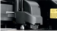
Abb. 4.6-16: Schneidekopf mit Sensor und Tangentialmesser
