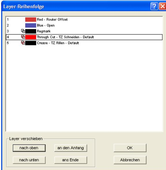
Abb. 4.2-6: Werkzeugreihenfolge umsortiert - „Durchschneiden“ jetzt vor Rillen
