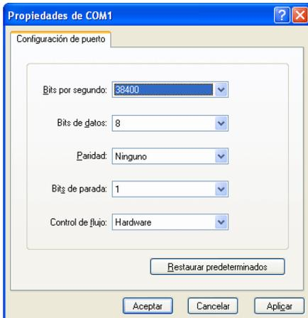
Fig. 3.6-22: Diálogo para la configuración de los parámetros del puerto
