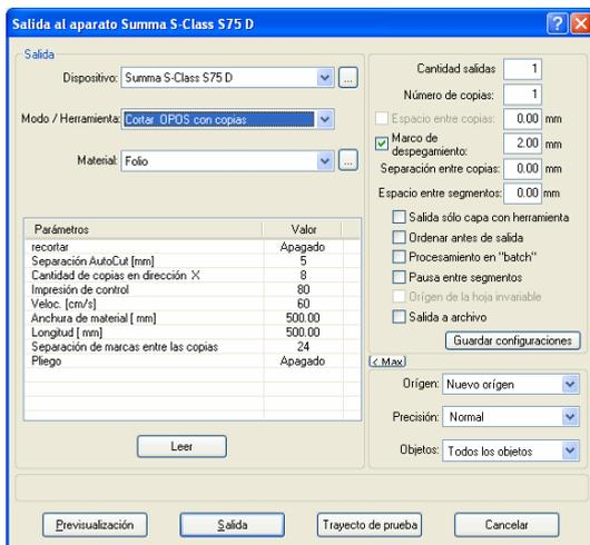
Fig. 3.6-18: Configuración de parámetro en el caso de copias idénticas de Jobs desde el rollo (también posible con hoja, cuando se colocará el parámetro „Plegio=Apagado”)
