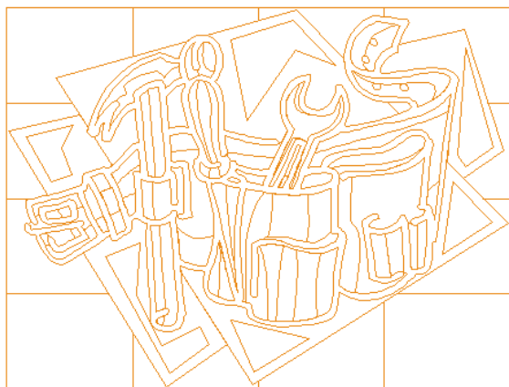
Fig. 4.4-17: Résultat de sortie avec lignes d'échenillages
