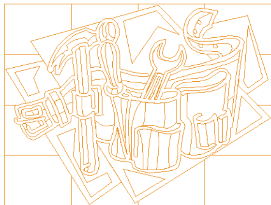
Abb. 2.5-5: Ergebnis der Ausgabe mit Entgitterlinien - Objekte nicht! durchgeschnitten
