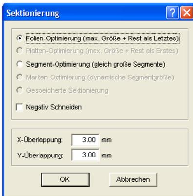
Abb. 2.5-6: Sektionierungs-Dialog mit Überlappungswert von 3 mm
