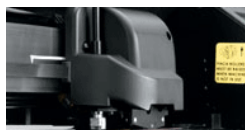
Fig. 2.9-4: Tête de découpe avec capteur et lame tangentielle
