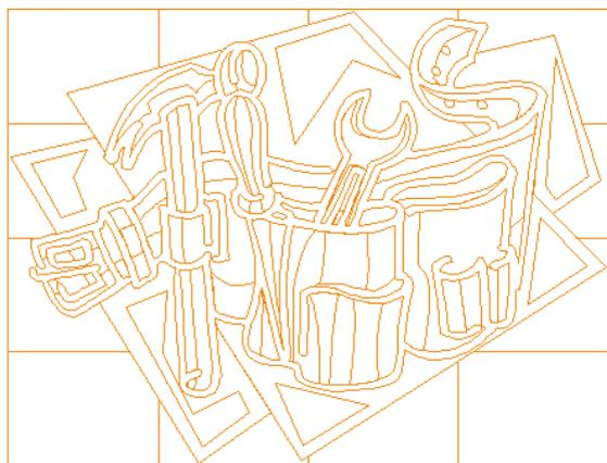
Fig. 3.5-5: Résultat de sortie avec lignes d'échenillages
