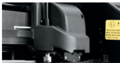
Fig. 4.10-4: Tête de découpe avec capteur et lame tangentielle
