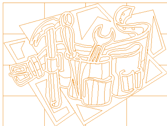
Fig. 4.11-5: Résultat de sortie avec lignes d'échenillages
