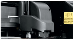
Fig. 3.10-5: Cabeza de corte con sensor y cuchilla tangencial
