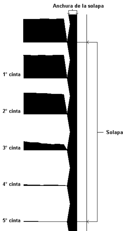
Fig. 7.15-8: Ejemplo para cintas por solapa, la anchura de la solapa y las cintas
