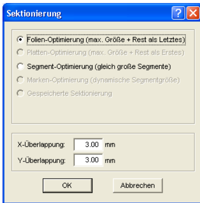
Abb. 4.12-6: Sektionierungs-Dialog mit Überlappungswert von 3 mm
