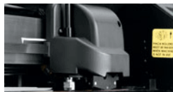
Fig. 3.11-5: Cabeza de corte con sensor y cuchilla tangencial
